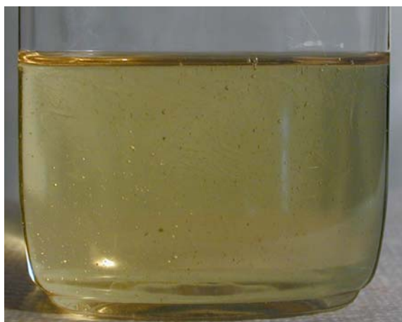
Hydraulikolie med vand på bunden
